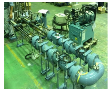
写真-1 ポンプ圧送性評価装置
