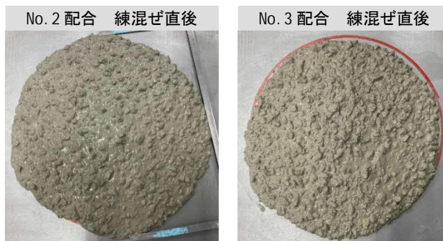
写真-1 スランブフロー試験
