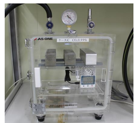
写真-1 供試体養生状況の例
