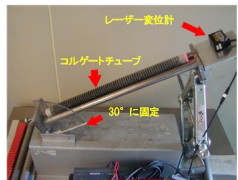
図-1 長さ変化試験装置
