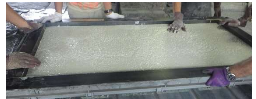
写真1 カーボンリサイクル板の製造状況
