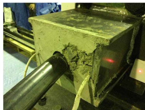
図-4 埋込部の破壊
