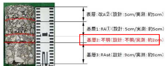
図3 湿式採取コアと切削残り (No. 1)
