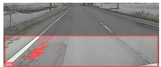
図-3 正検出の例(真陽性、ポットホールを検出できている)
