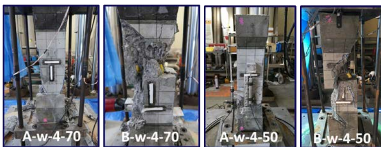
図-4 試験体の破壊状況
