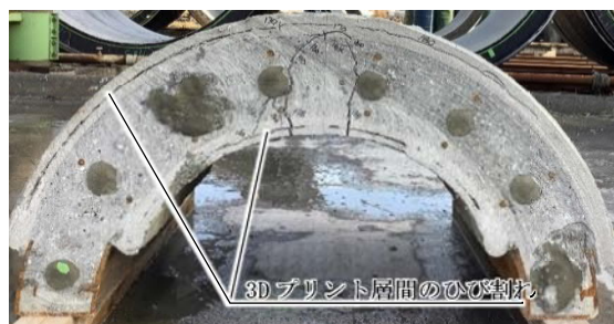
写真-2 流込み試験体載荷後
