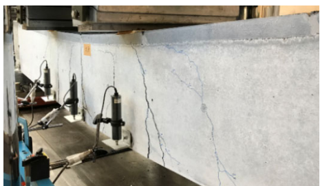
写真-1 終局荷重前の埋設型枠の一体性
