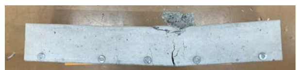
図-6 ひび割れ発生状況 (Case2)
