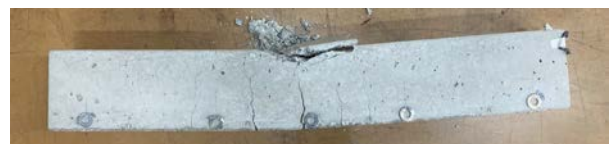
図-5 ひび割れ発生状況 (Case1)
