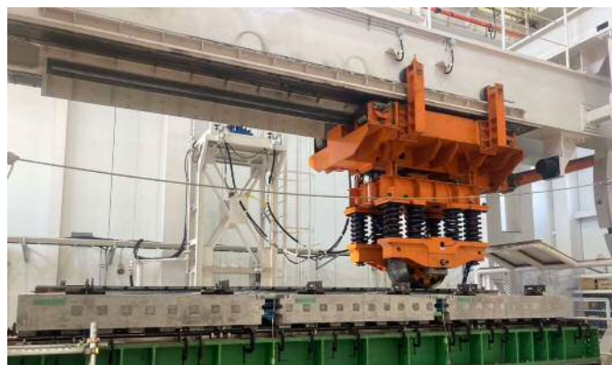
写真-1 輪荷重走行試験状況
