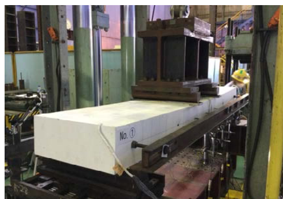
写真-2 静的載荷試験状況
