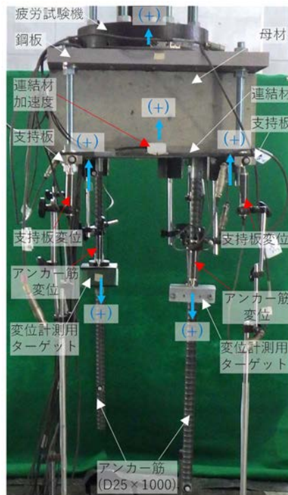
写真-4 加振状況および計測状況
