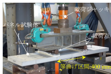
写真-1 試験体のセットアップ状況（Case1）
