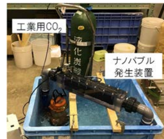
写真-1 ナノバブル CO 2 溶解水の製造状況
