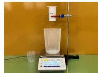
写真-2 通水試験状況
