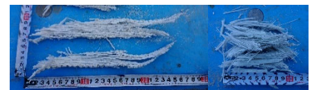
写真-5 GFRP 切削片の比較(左からケース-1, 2)
