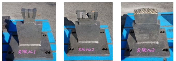
写真-2 切削ビット (左から従来型・試作ビット-1・2)
