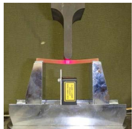
写真-1 曲げ強度試験の実施状況
