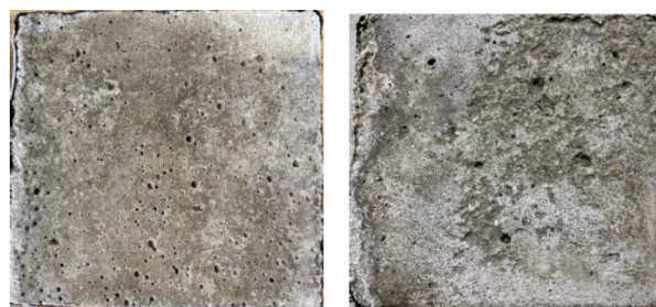
図2 ①滑らかな面 図3 ⑦荒れた面
