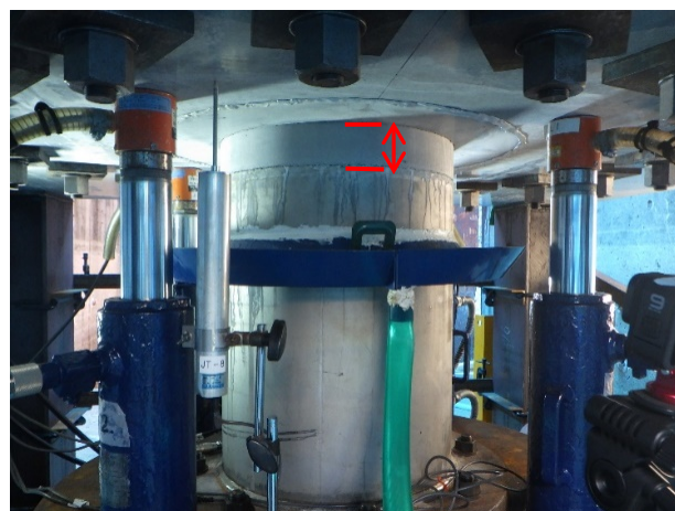
図-3 性能評価試験終了時の鋼製配管抜け出し状況
