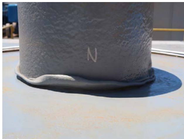
図-4 性能評価試験終了後のポリウレア樹脂状況
