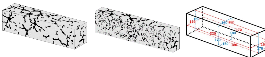
(a)ひび割れ分布図(左：表面，右：内部)
