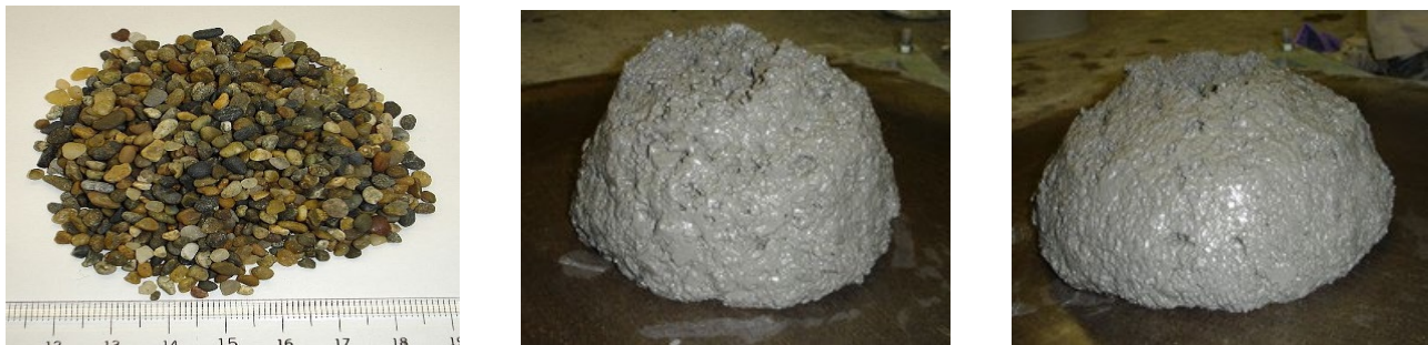
写真-1 本検討で用いた単粒砂(左)と単粒砂を用いたコンクリートのスランプ(中央: s/a=37\% , 右: s/a=57\% )
