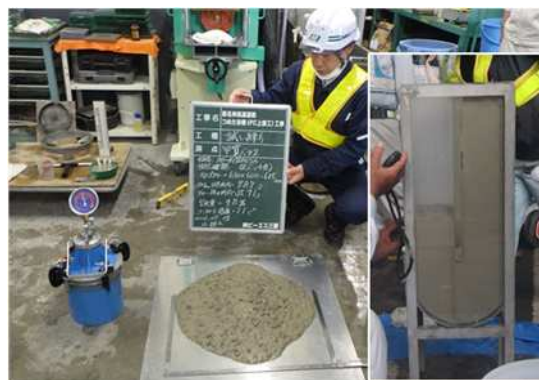
写真-2 BFS 高流動コンクリートの品質試験状況
