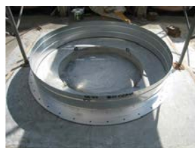
写真-2 下端の固定治具
