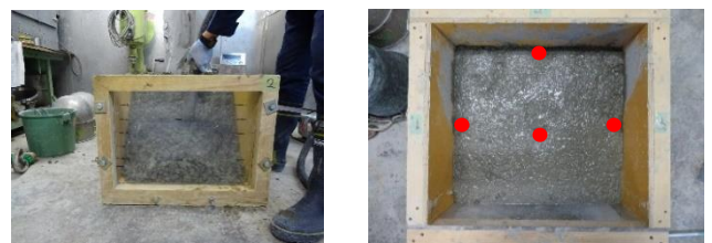
写真-1 模擬型枠を用いた試験の状況
