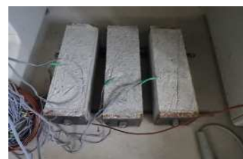
写真-2 収縮ひずみ計測状況
