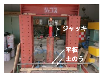
写真2 繰返し平板載荷試験の外観
