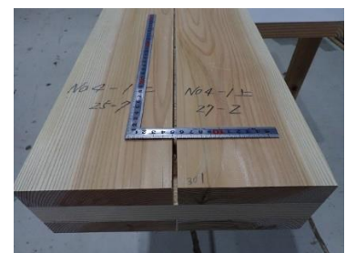
図-3 幅ぞりに伴う隙間 (No.4)
