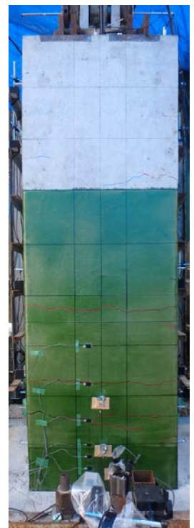
写真-1 シートの巻き立て状況
