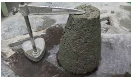
写真-1 スランプ試験状況 (配合 No. 3)
