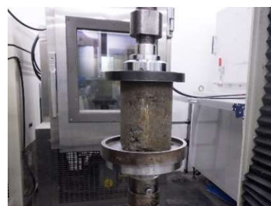
写真-2 一軸圧縮試験状況
