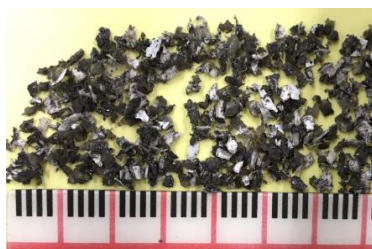
図1. 使用した廃パネル樹脂
