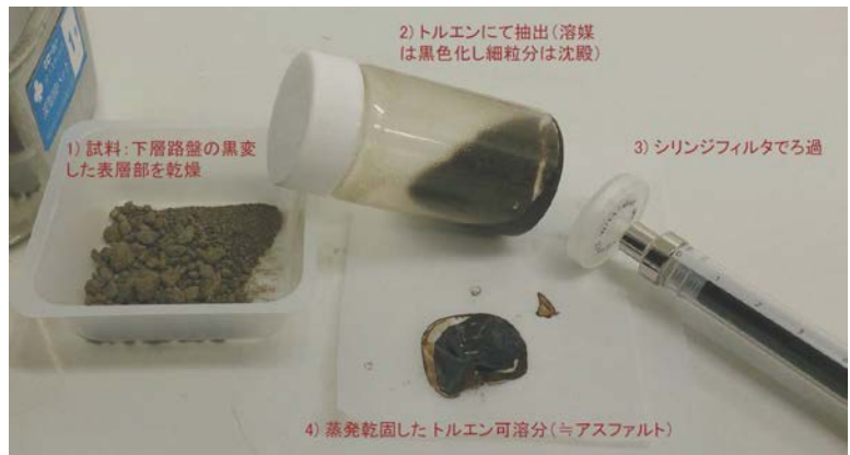
図-2 路盤材の抽出試験手順
