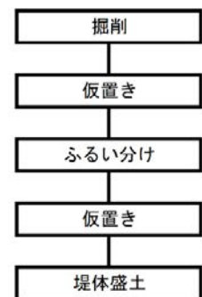
図-4 施工フロー
