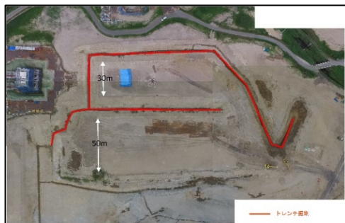
図-5 トレンチ掘削
