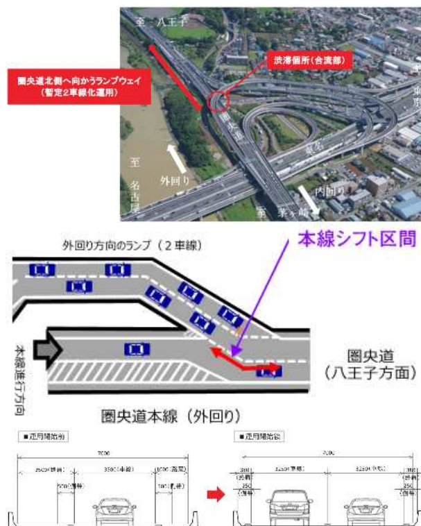
図1 暫定2車線化概要（海老名JCT）
