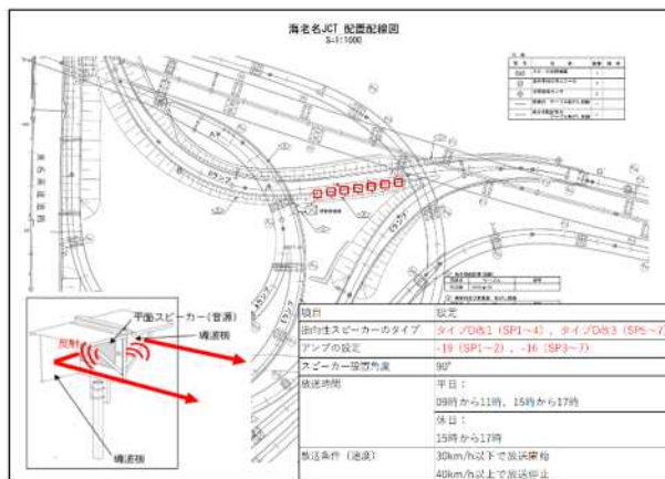
図3 海老名JCT 指向性スピーカー配置図
