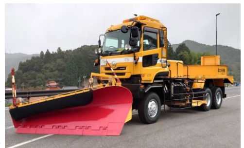
図2 除雪トラック (国土交通省中国地方整備局三次河川国道事務所)
