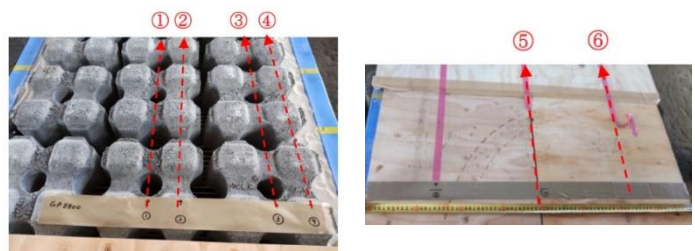
(a) ブロックマット (b) 合板のケース 写真-3 レーダ探査の走査ライン位置
