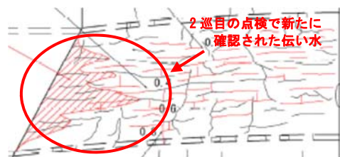
— : 1巡目に記入漏れのあったひびわれ
