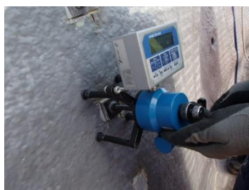
写真7 付着試験状況
