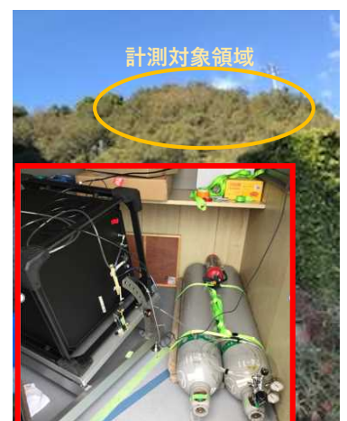
写真-1 検出器設置状況
