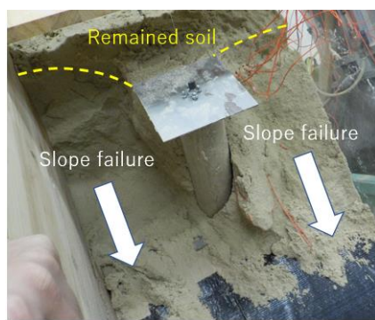
図5 崩壊の様子(Case-C)
