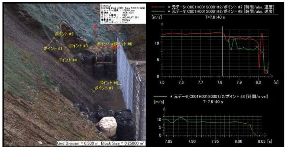
図-2 土石流速度と実験状況
