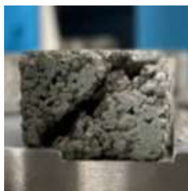
図-5 破壊後の供試体断面図
