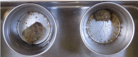
図-4 水浸24時間後の状態(コアB 0.88~0.93m)
