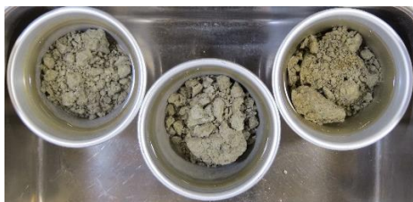
図-3 水浸24時間後の状態(コアA 0.85~1.00m)
