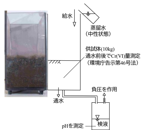
図-3 通水洗浄試験の概要
