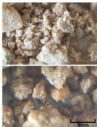
写真 1 改良前(上)と改良後(下)の赤土
