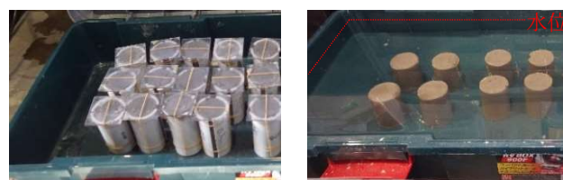
写真 1 供試体の養生状況
