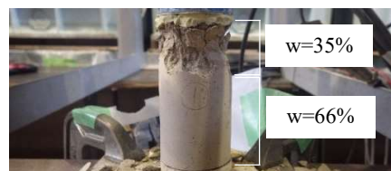
写真 2 破壊状況 (タイプ 600, 材齢 400 日)
