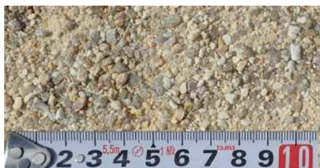
写真-1 まさ土盛土の転圧面
